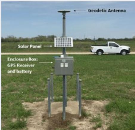
**Ejemplo de una Estación GPS Permanente**
