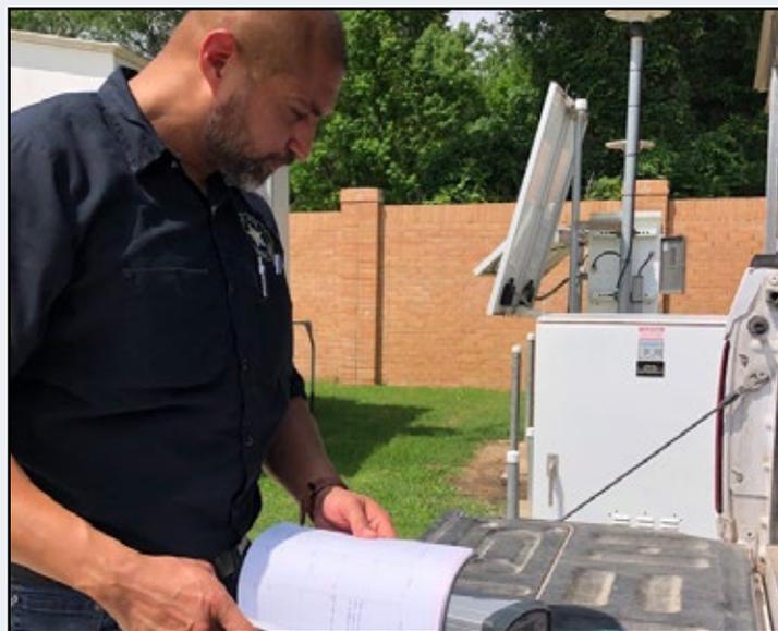
*Revisando documentos en una estación GPS de monitoreo de hundimiento*
